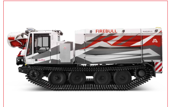
Minimale Bodenbelastung durch Raupenfahrgestell
