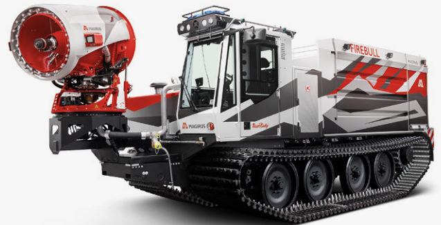
PowerBully 18T mit Magirus Aufbau – 10.000 l Löschmitteltank
