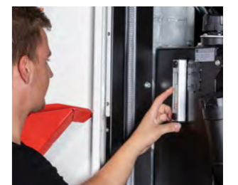
Contrôle aisé des niveaux d'huile à l'aide d'un niveau visuel
