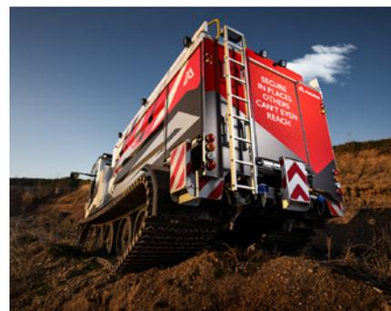
Hohe Nutzlast, geringster Bodendruck: ca. 30 Mal geringer als bei einem 6x6 LKW
