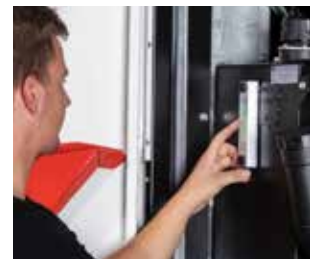
Facile controllo dei livello dell'olio grazie a vetri spia
